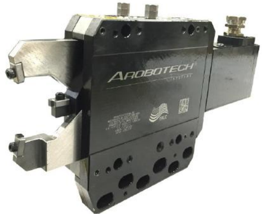
修理/翻新后的中心架
